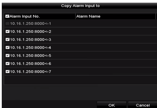
Figura 8-9 Copia delle impostazioni dell'ingresso di allarme
