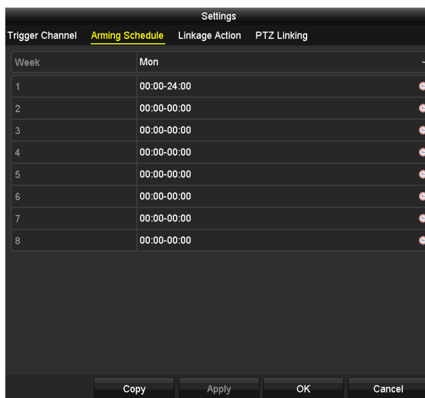
Figura 8-7 Impostazione della programmazione per l'ingresso di allarme
