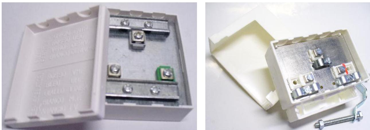
*I partitori serie 411xx sono realizzati con contenitore in materiale plastico e destinati a dividere il segnale TV terrestre su 3 o 4 uscite a seconda dei modelli. Permettono la telealimentazione degli amplificatori d' antenna e presentano una attenuazione del segnale rispettivamente di 6 e 8 dB.*
