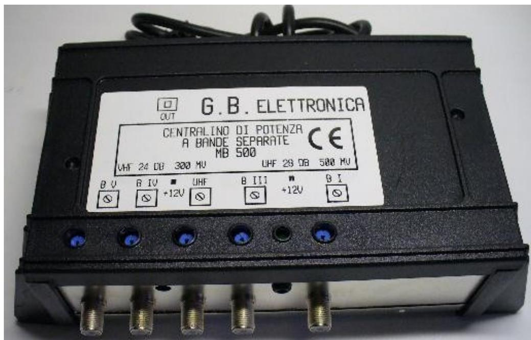
*La serie di centralini autoalimentati multibanda serie MB sono destinati agli impianti d' antenna di piccole e medie dimensioni (indicativamente da 6 – 7 a 13 – 15 prese) e si distinguono per la buona linearità e la disponibilità di quattro versioni con due livelli massimi di uscita e diverso numero di ingressi, come indicato nella tabella più in basso.*
