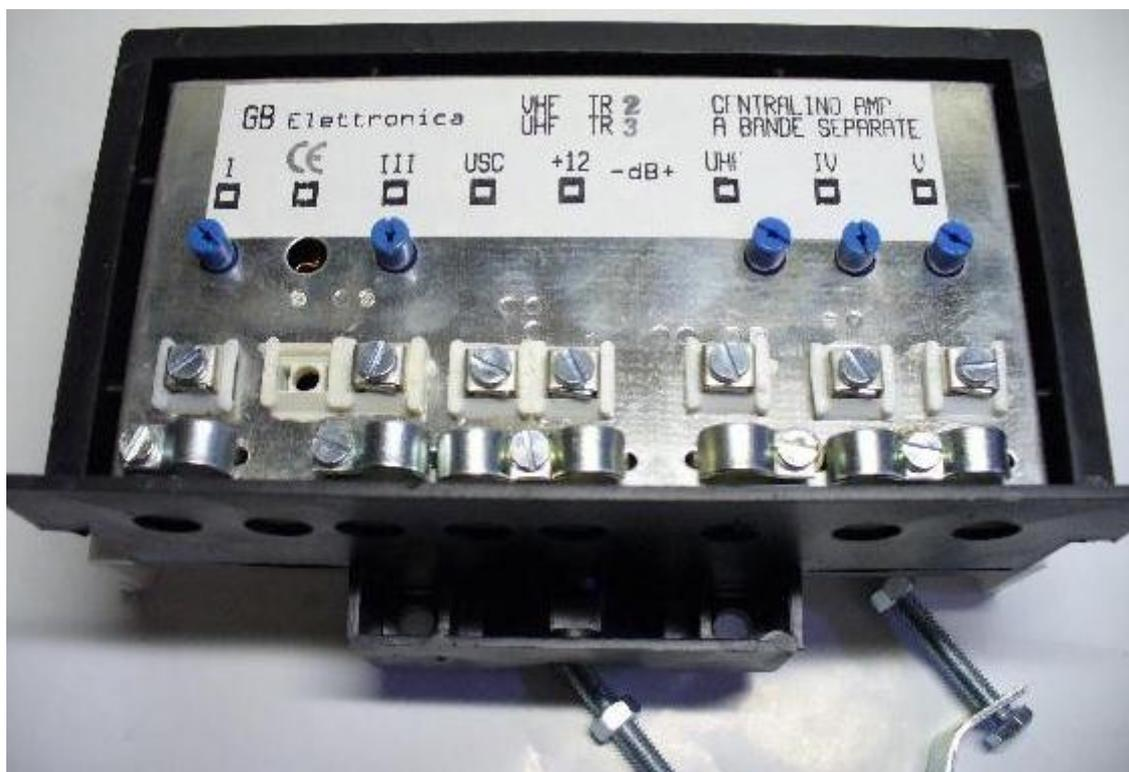
*Gli amplificatori da palo della serie MB5 dispongono di due sezioni amplificatrici, una da circa 18 dB per la banda VHF e una da circa 27 dB per la banda UHF, e sono dotati di morsetto per la alimentazione di un eventuale preamplificatore supplementare (morsetto +12).*
