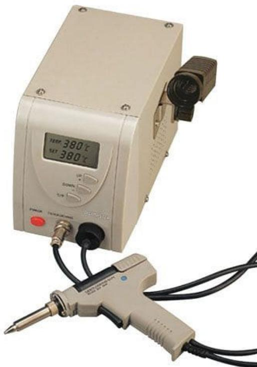
*Stazione dissaldante pratica e funzionale, con ampio display e di facile utilizzo. Indicata per l'impiego in laboratorio per la dissaldatura di componenti su schede pcb. Disponibile un kit di ricambio con tre ugelli dissaldanti.*
